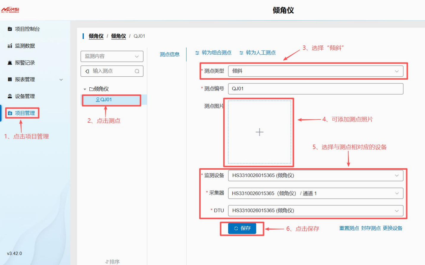
图 3.2.2-3 SDM30 倾角仪进行测点关联
